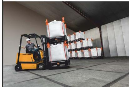
Manipolazione del telaio Big-Bag NEVA con carrello elevatore / max. 2 x 1.500 kg
