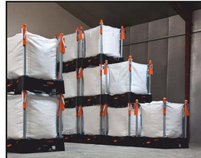
Metodo di stoccaggio verticale per i Big Bag con sistema NEVA. Tenuta massima 4 x 1.500 Kg.
