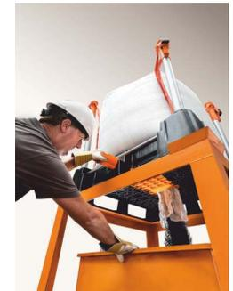
Svuotamento manuale con dosaggio e opzione di bloccaggio.
